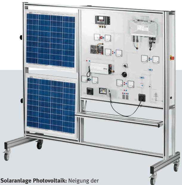
**Solaranlage Photovoltaik:** Neigung der PV-Module sind stufenlos verstellbar von 0-90°.
