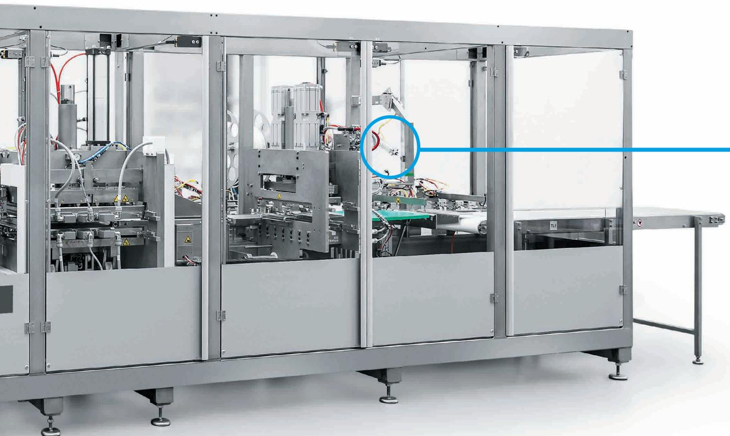
**Schnell und präzise:** Die Anlage zur Herstellung von Infusionsbeutel fertigt bis zu 6500 Stück pro Stunde.
