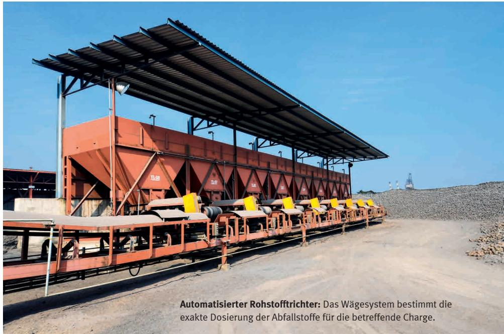
**Automatisierter Rohstoffrichter:** Das Wägesystem bestimmt die exakte Dosierung der Abfallstoffe für die betreffende Charge.
