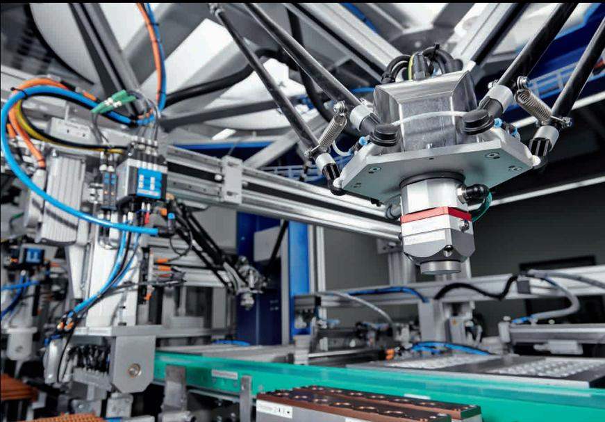
**Der Delta-Roboter greift mit einem speziellen Vakuumgreifer Teile vom Band und bestückt wahlweise Gitter- oder Jedec-Trays.**
