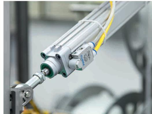
**Spart Einbauraum:** das Drossel-Rückschlagventil VFOF-LE-BAH.
