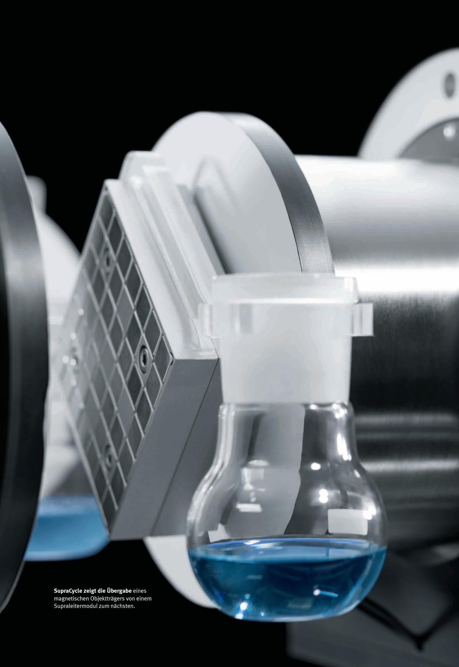
**SupraCycle zeigt die Übergabe** eines magnetischen Objektträgers von einem Supraleitermodul zum nächsten.
