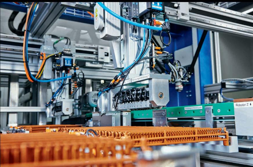
**Die elektrische Achse EGC-HD, bekannt für ihre Steifigkeit und Präzision, bewegt einen mechanischen Greifer horizontal. Dieser hebt mehrere Teile gleichzeitig, schwenkt um 90° und legt sie in ein Gittertray.**
